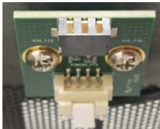
Fan Power Connector on GEB-3601
